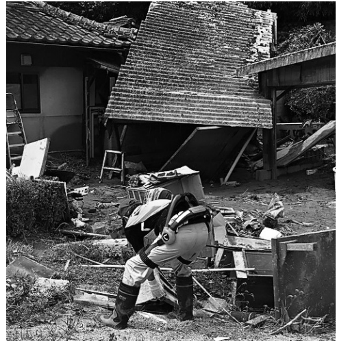
図2 HAL 腰タイプ作業支援用装着による 災害支援（写真提供：サイバーダイン）
