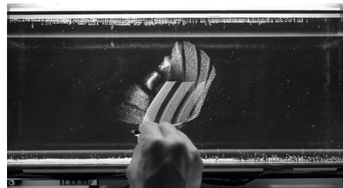
図5 電極表面での気泡の成長を抑制するような条件で掃引した際の気泡の様子
