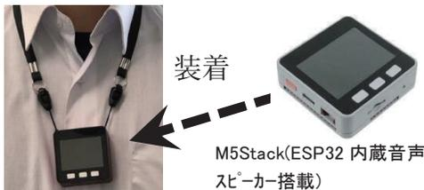
図8 サーバ側 ESP32の装着
